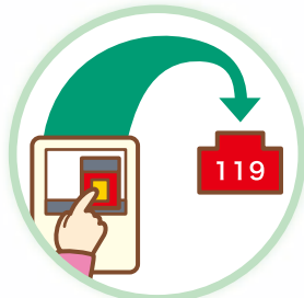
火災通報装置
