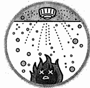
スプリンクラー設備
