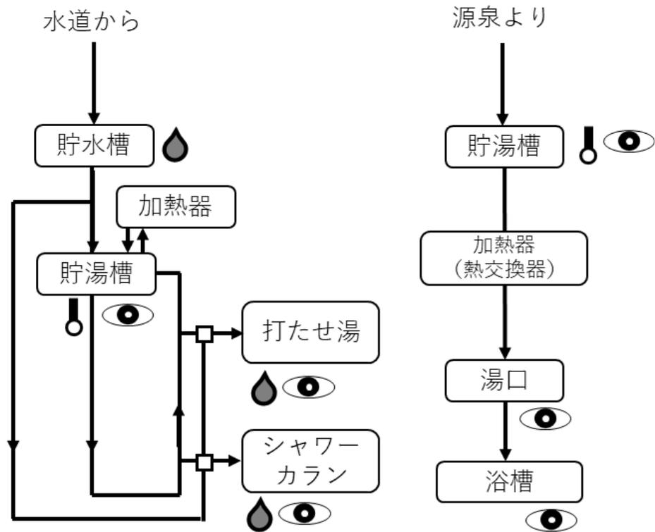
この図はかけ流し式浴槽のモニタリングの1例を示しています。
