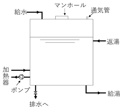
貯湯槽（源泉槽を含む）は浴槽までの配管が短くなるよう、できるだけ浴槽に近接して設置することが推奨されます。また、水抜管を槽底の最低部に取り付けるなどにより、完全に排水できる構造とします。これにより内部の洗浄を確実に行うことができます。
