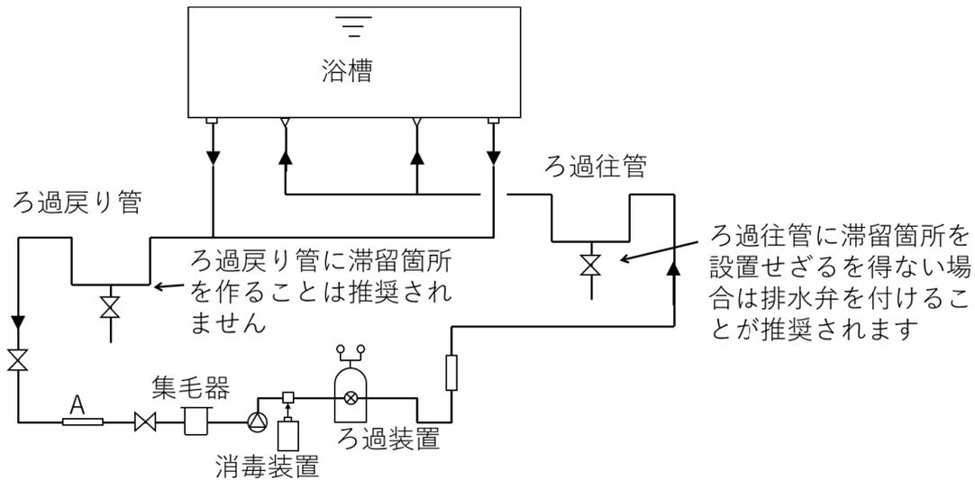
水を循環可能な水位まで減らし、循環配管などの材質の腐食を考慮して5～10 mg/L の遊離残留塩素濃度<sup>注</sup>で数時間循環させた後、必要に応じてチオ硫酸ナトリウムで遊離残留塩素濃度を下げて排水します。この操作を換水の都度行うことで、循環配管への生物膜の蓄積を防止することができます。循環配管洗浄の際は、水位計配管や連通管も同時に行うようにしてください。詳細はII-1 2. 水位計及び水位計配管及びII-1 3. 連通管の項を参照ください。
