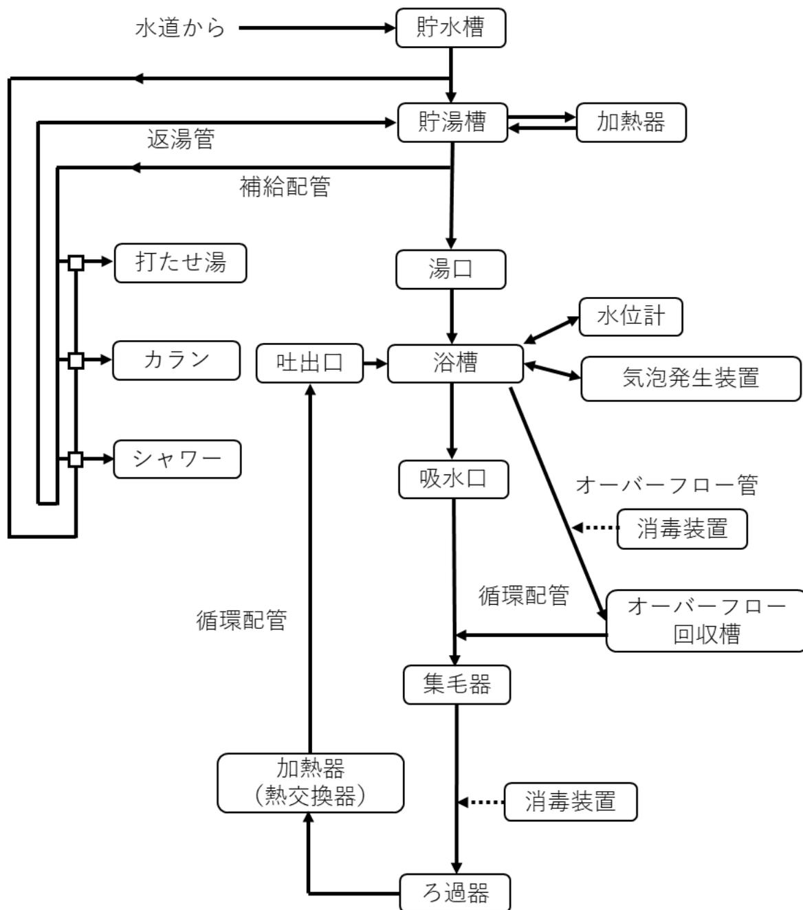
配管図等の図面を参照しながらチームで現場確認を行った後に作成する簡略図(流れ図)の例を示します。簡略図を作成すると施設の状況が把握しやすくなり、3) レジオネラ属菌が増殖、拡散しうる設備・箇所の特定期間で使用することもできます。この図は循環式浴槽の例を示しています。ここで示す図は書き方の例ですので、それぞれの入浴施設の設備の設置状況に合わせて図を作成してください。
