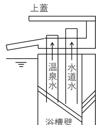
ように湯口内に別々の配管とし、水道水を上流側にします。内部は上蓋を外して洗浄・消毒します。
