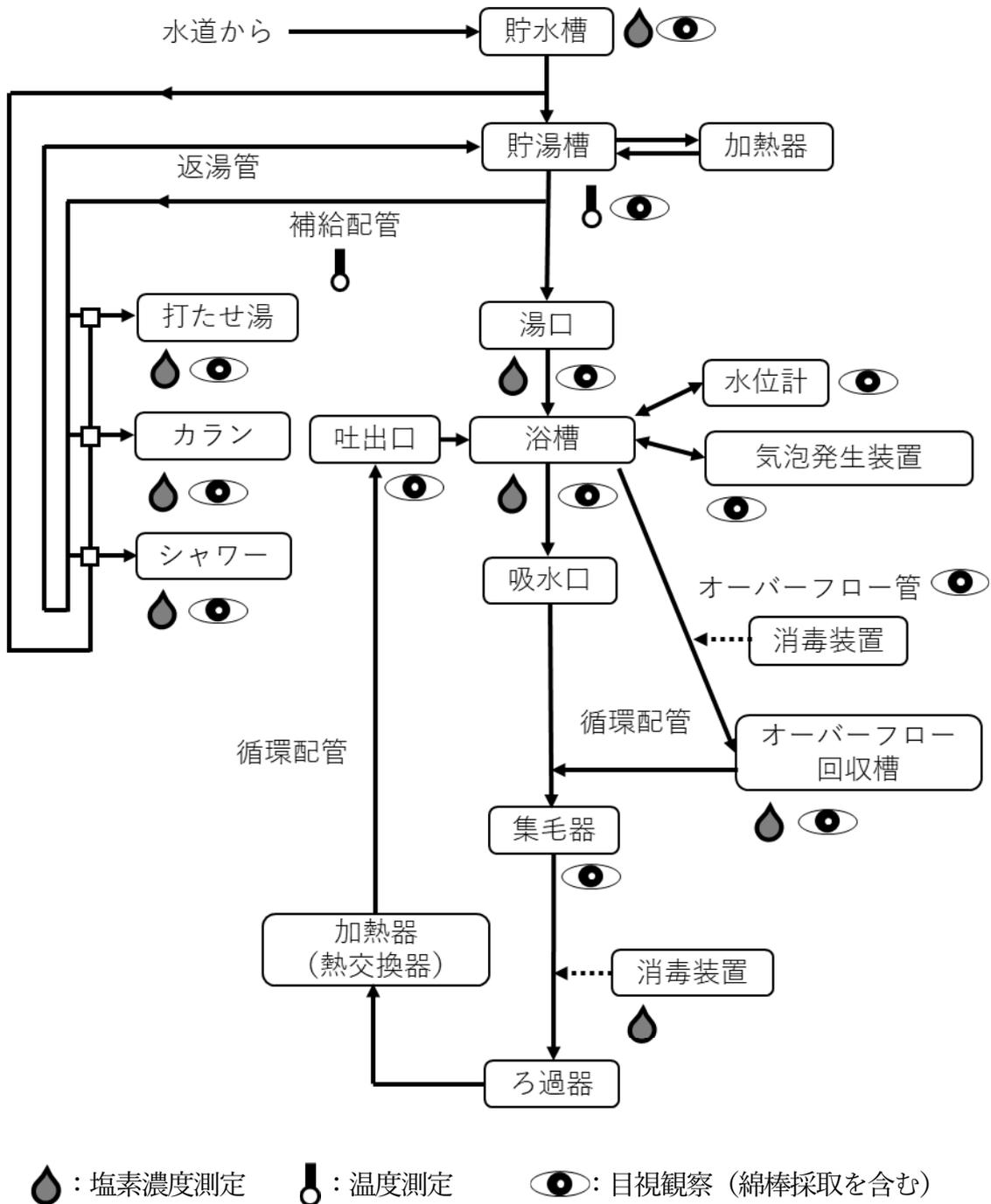
各施設の状況に置合わせて重点的に管理する設備や箇所を決め、モニタリング方法を設定します。モニタリング方法として測定方法と管理に必要な濃度や温度を設定します。循環式浴槽でのモニタリングの例を示します。この図は1例ですので、設備の設置状況等に応じて適宜設定してください。
