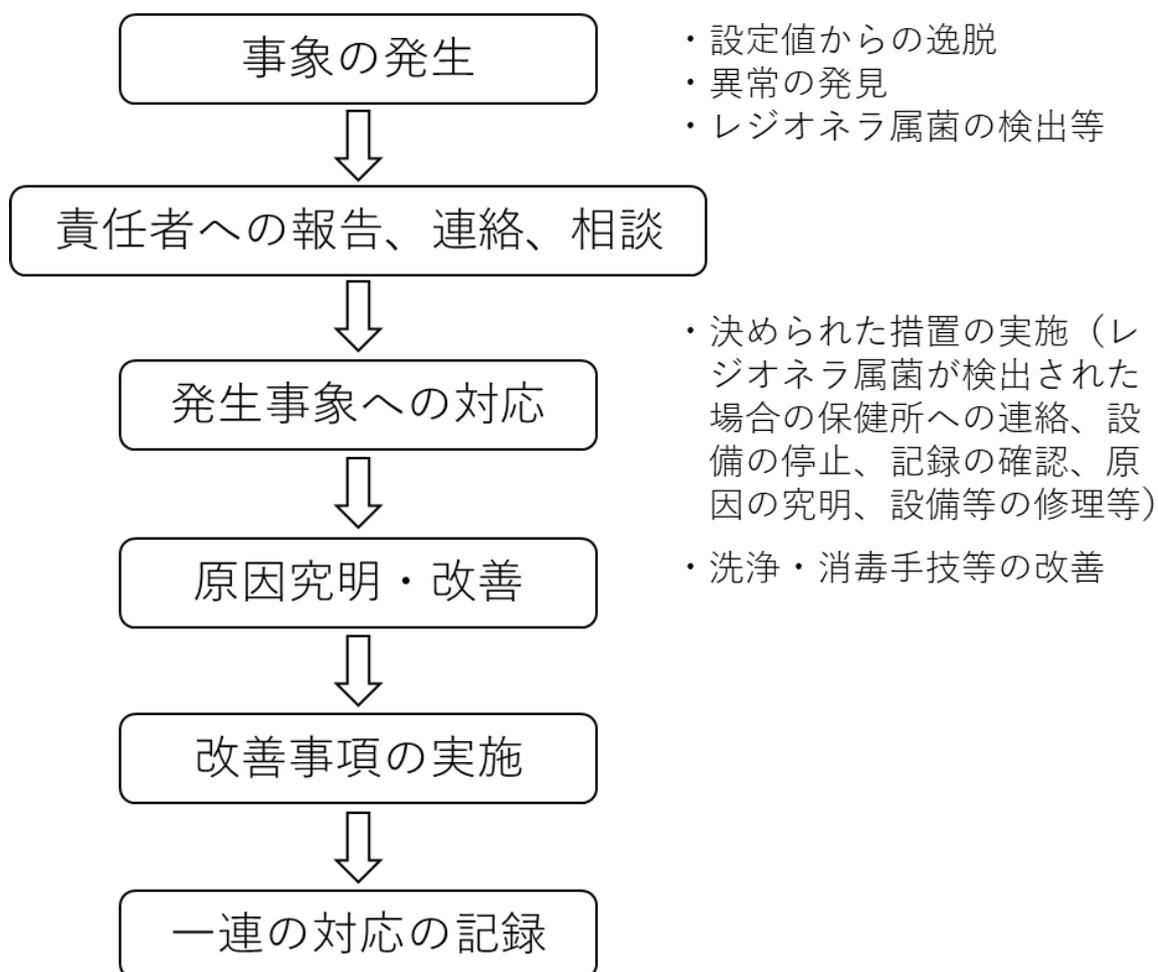
貯湯槽水の温度や浴槽水の遊離残留塩素濃度などの予め設定した温度や濃度（基準値）から逸脱した場合、あるいは生物膜が形成された、レジオネラ属菌の増殖が明らかになった場合等の逸脱が発生した場合の措置を決めておきます。対応の流れの概要の例を図に示します。
