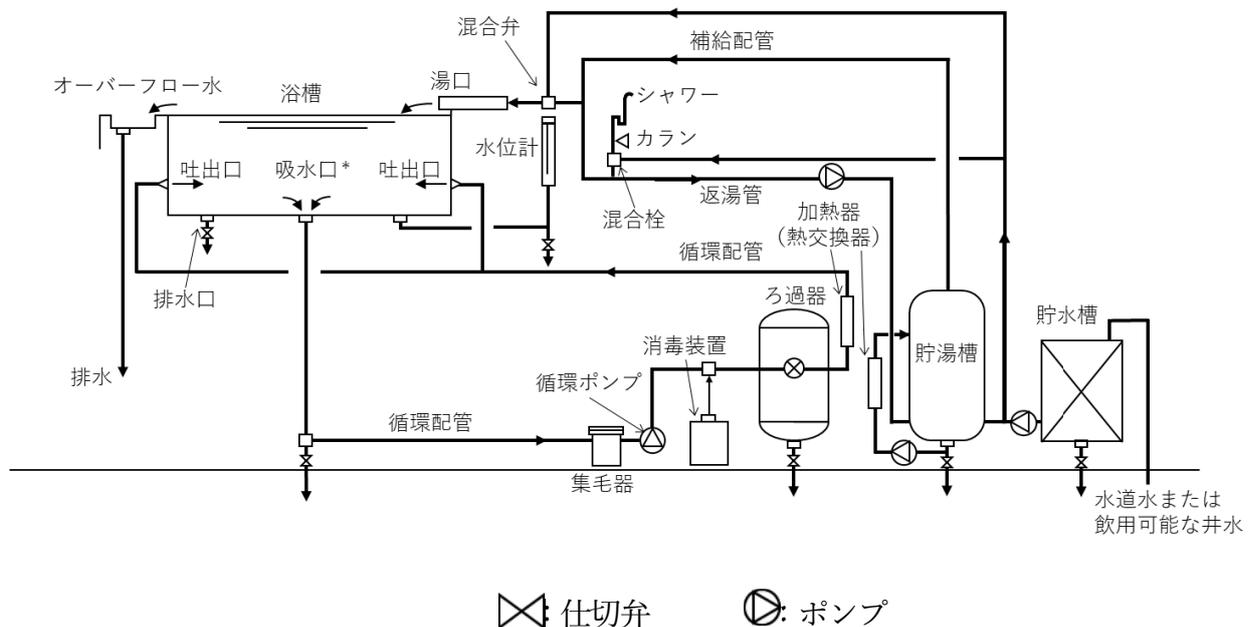
この図は温泉を原水とする循環式浴槽施設の概要の例です。点線は設置している場合とない場合があることを示しています。
