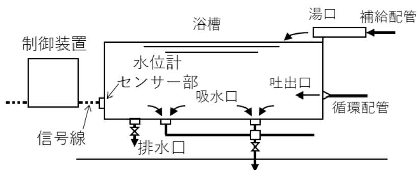
やむを得ず水位計配管を設ける場合は、水位計をできるだけ浴槽に近付けて配管を短くし、浴槽側に下り勾配を設けて、浴槽換水時に完全に排水できるようにし、内部を洗浄・消毒できる構造にします。配管に立ち上がりの部分がある場合は滞留しやすいため、水抜きを設けて排水と洗浄・消毒がしやすい構造とします。
